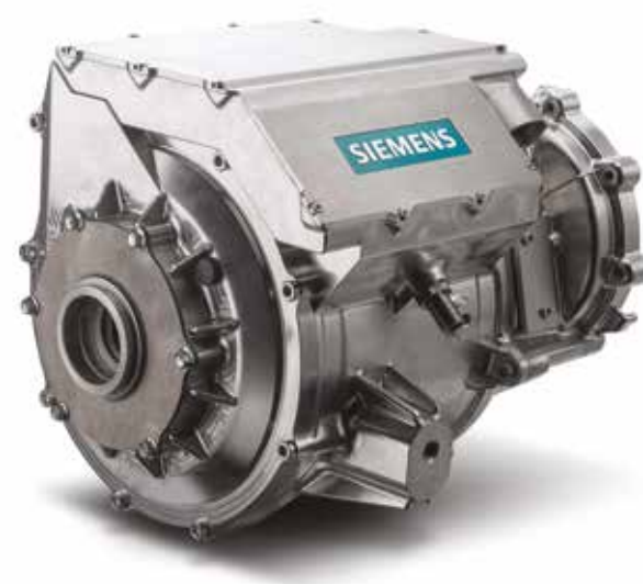
Siemens is vorig jaar met een nieuw type elektromotor gekomen, die met een gewicht van vijftig kilo een continuvermogen van 260 kilowatt levert, vijf keer zo veel als vergelijkbare aandrijfsystemen. De motor is uitgetest in de Extra 330LE, een tweepersoons vliegtuig van duizend kilo. Siemens werkt op dit gebied samen met de bouwer, EXTRA Flugzeugbau.
